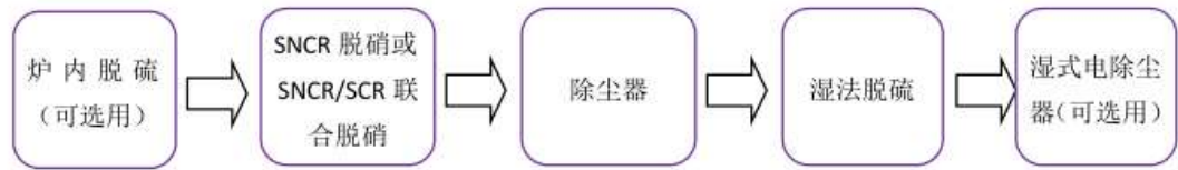
图 2 超低排放工艺流程 2（循环流化床锅炉）
